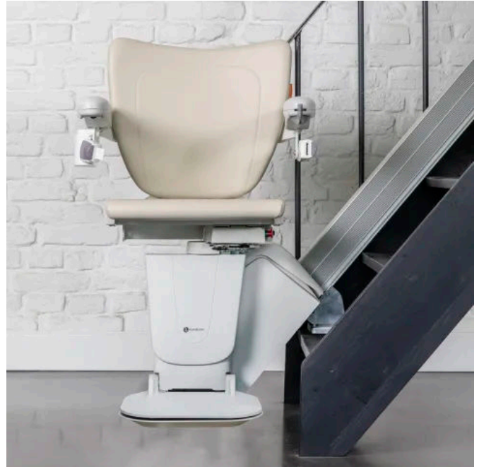
Handicare 1100 ist ein besonders schlanker Treppenlift, der sich für schmale Treppen mit 25°-50° Neigung eignet.
