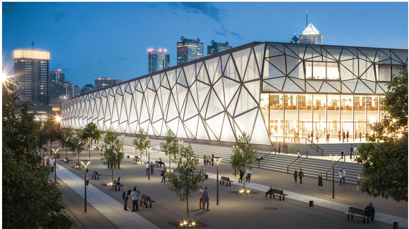
Die Schüco Fassadensysteme FACID ermöglichen vielfältige Fassadengestaltungen. Die Formen können als Rechteck, Quadrat, Trapez, Vieleck oder in gebogenen Lösungen realisiert werden. Der Einsatz von Hightech-Textilien gewährleistet multifunktionale Anwendungen wie Sicht-, Sonnen-, Blend- und Wetterschutz; optional sind auch nach Brandklasse A2 klassifizierte Glasfasergewebe einsetzbar.
