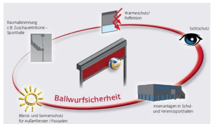
Brichta-Ballwurfsichere Anlagen und ihre Einsatzbereiche
