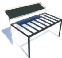
Überdachung mit externem Solarmodul
