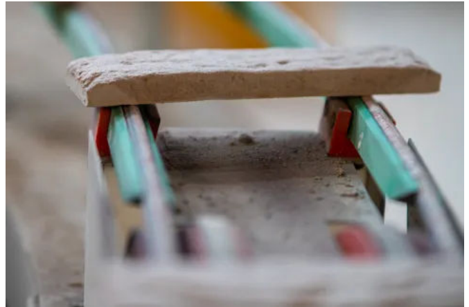
Das Produktionsverfahren kombiniert eine echte Handformpresse mit einer digitalen Engobierung und gezielten Besandung.
