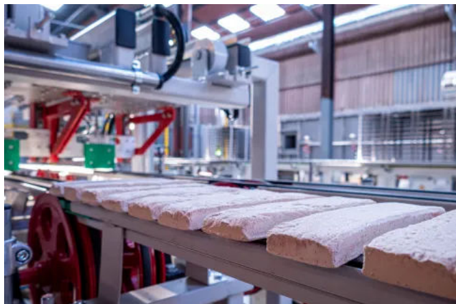
Terca Mistral Riemchen werden in einem weltweit ersten Handformverfahren hergestellt und im elektrischen Ofen gebrannt.
