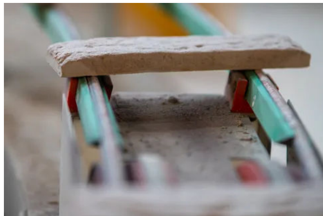
Das Produktionsverfahren kombiniert eine echte Handformpresse mit einer digitalen Engobierung und gezielter Besandung.
