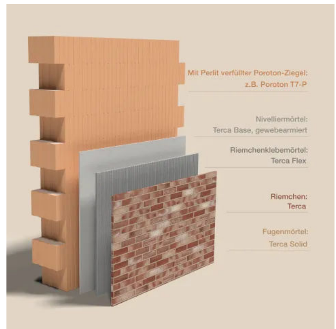
wienerberger ONE ist ein Ziegel-Wandsystem mit integrierter Dämmung und keramischer Riemchenfassade.
