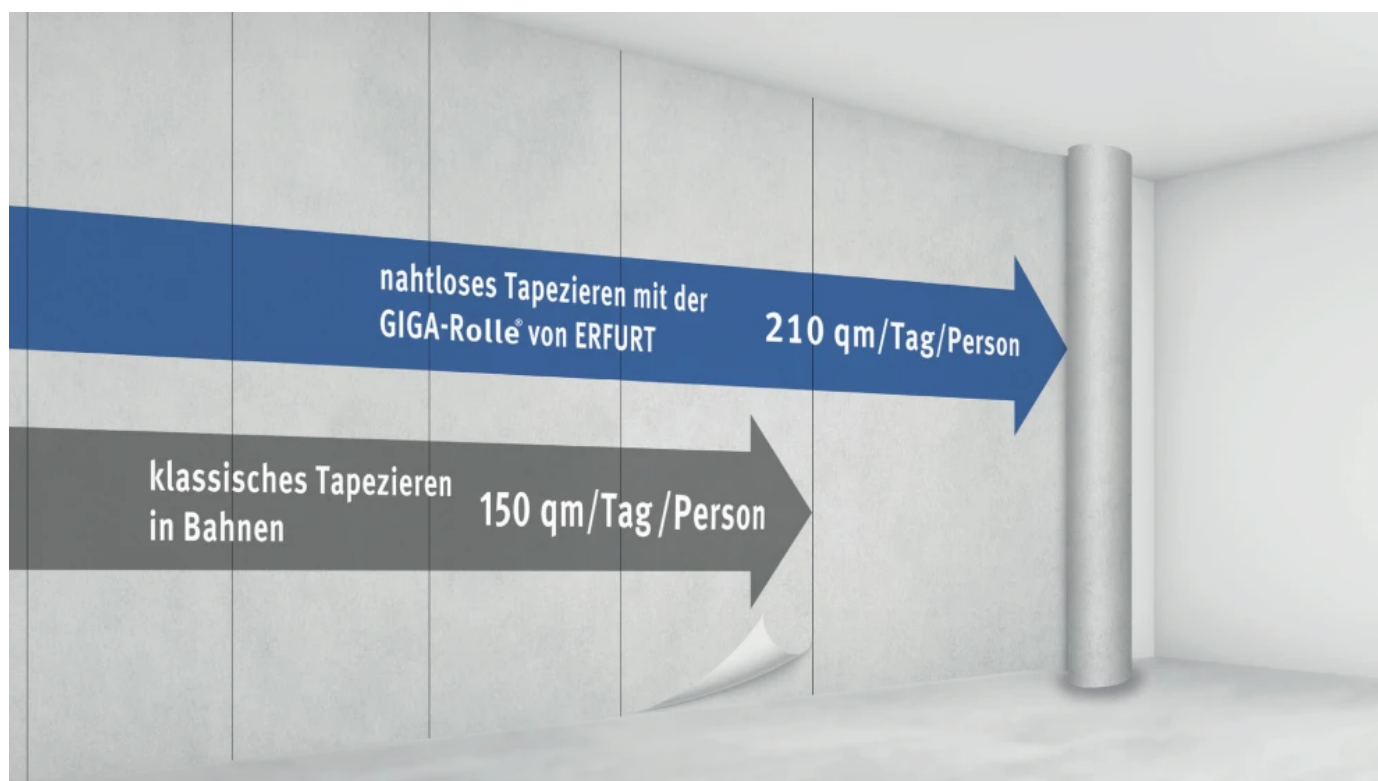
Klassisches Tapezieren in Bahnen vs. GIGA-Rolle®
