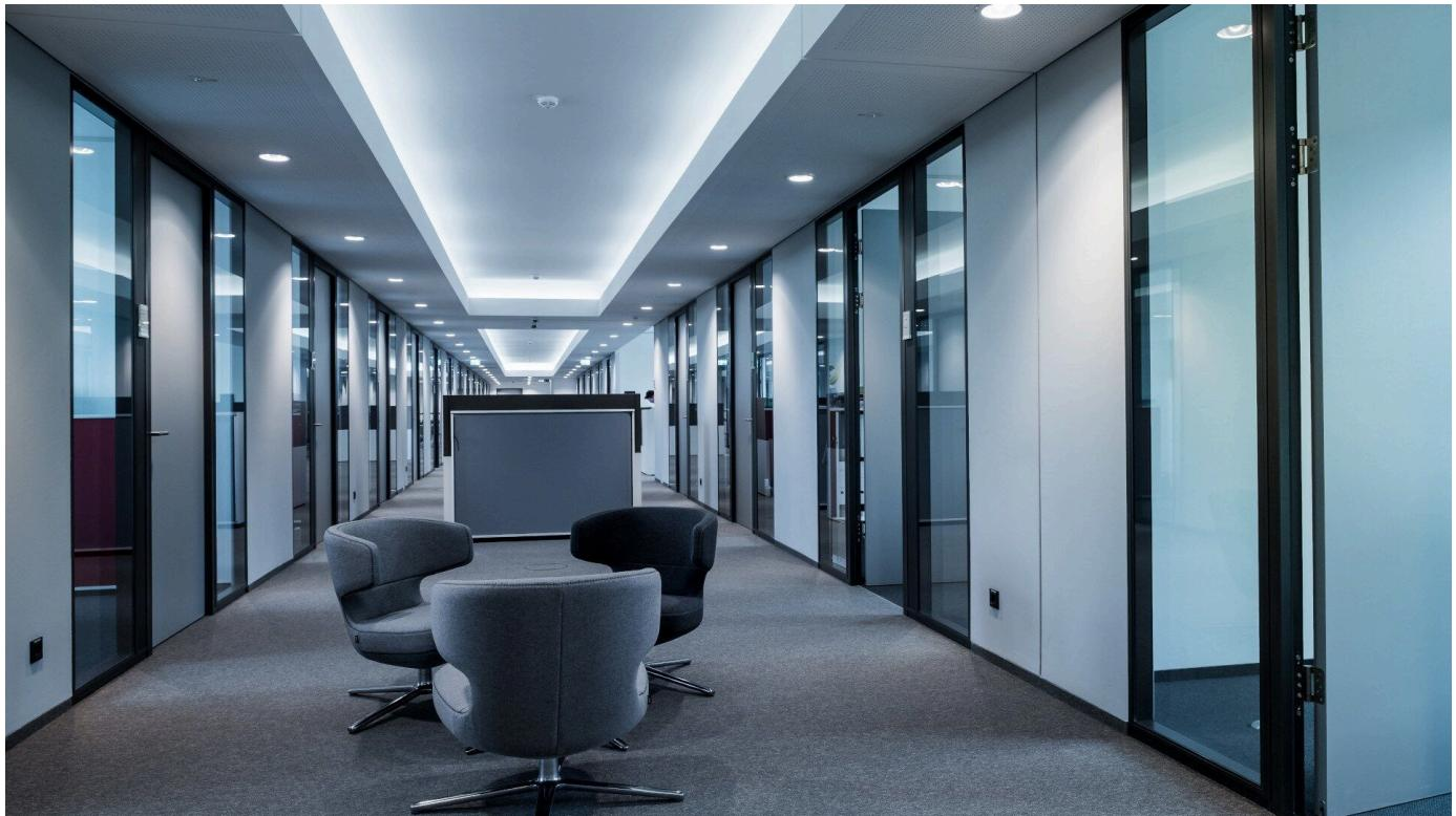
Seit mehr als 40 Jahren im Einsatz - Mit einer Konstruktion basierend auf Systemstützen und Rahmenverglasungen zählt die Lehnertwand 82 zu den klassischen Trennwandsystemen. Die Wandstärke beträgt 82mm. Verglasungsrahmen sind mit 17,5 oder 36mm Ansichtsbreite ausführbar. Neben den Verglasungen sind Vollwandausführungen mit Holzwerkstoffplatte mit HPL-Dekor oder aus Stahlblech mit einer innenliegenden Trägerplatte aus Gipskarton möglich.
