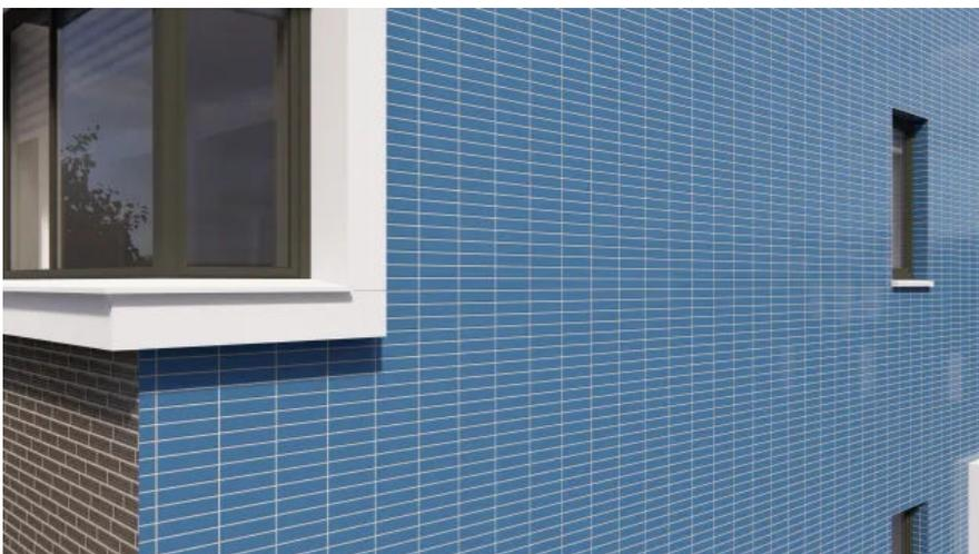
Die lebendigen, naturnahen Farben entstehen durch eine Kombination aus spezieller Glasurtechnik und traditioneller Brenntechnik im Tunnelofen. Beide Varianten zeichnen sich durch robuste Materialqualität aus, da die StoCera Elemente aufgrund ihrer geringen Wasseraufnahme frostbeständig, farbecht, UV-beständig und besonders wartungsarm sind.
