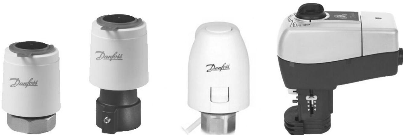
Thermische oder elektrische Stellantriebe ermöglichen in Verbindung mit Raumthermostaten oder Regelsystemen eine gradgenaue Ansteuerung von einzelnen Heiz- oder Kühlkreisen. Die kompakten thermischen Stellantriebe passen auf alle Danfoss Ventilgehäuse und auf Fremdfabrikate mit einem Anschluss M30 x 1,5 mm.
