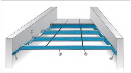
Konstruktionsbeispiel System MAXI Wand-zu-Wand-Konstruktion
