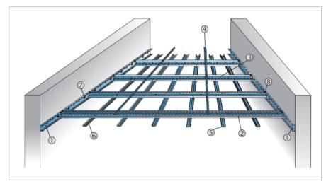
Konstruktionsbeispiel System MIDI Wand-zu-Wand-Konstruktion
