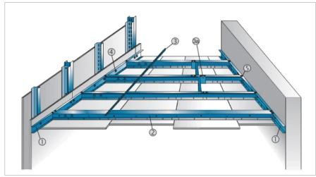
Konstruktionsbeispiel System MINI Wand-zu-Wand-Konstruktion
