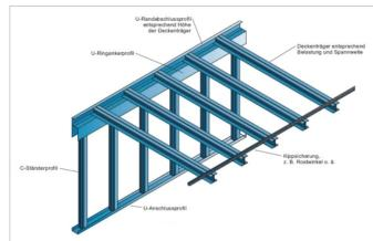
Beispielhafte Raumstruktur mit Edificio Stahlleichtbau
