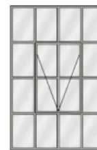
Senkklapp-Fenster nach aussen öffnend
