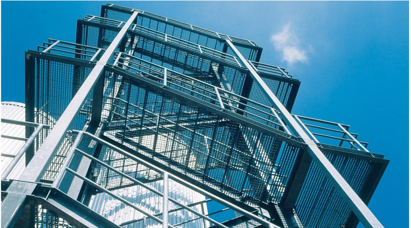
Systemtreppen HGT mit Stützen und Querträgern aus Profilstahl. Außenwangen aus Breitflachstahl, U-Profil oder Hohlprofilen mit den Tritten verschraubt.
