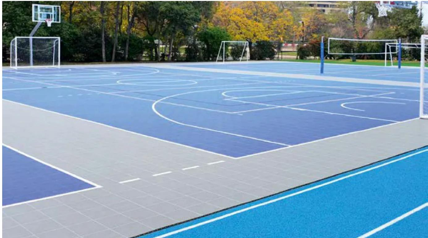
Der flexible Outdoor-Sportboden, bestehend aus einzelnen vollelastischen Fliesen, lässt sich schnell und einfach verlegen. Er ist pflegeleicht, wetterbeständig und das ganze Jahr über nutzbar.
