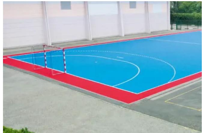
Ein neuer Sportboden ist schnell verlegt: Ein Spielfeld mit einer Größe von 1000m<sup>2</sup> ist von 4 Personen einschließlich Markierung in ca. 6 Stunden verlegt.
