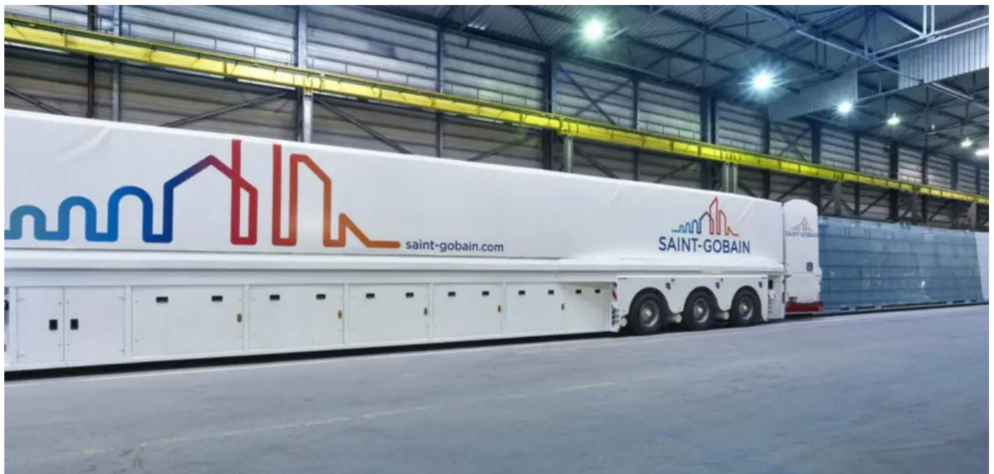
Glastransport mit eigens von Saint-Gobain entwickelten 18m-Truck
