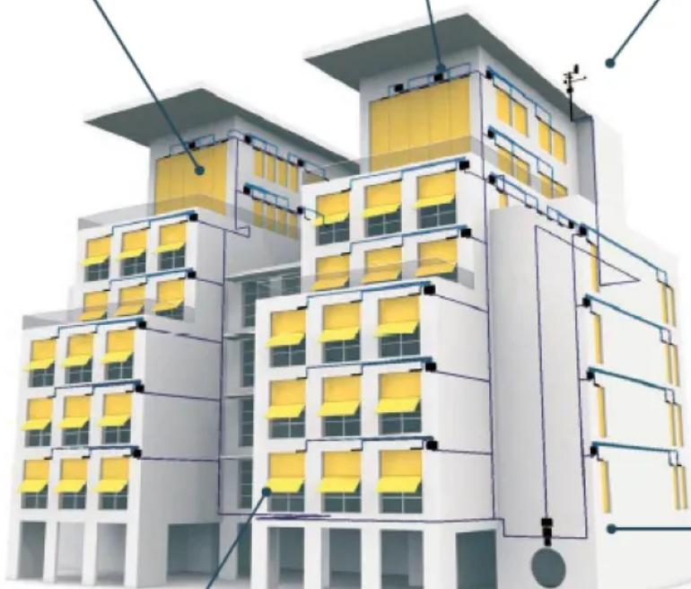
Die Zentralen (Building Controller) sind mit dem firmeneigenen Bus (IB+) und mit offenen Protokollen kompatibel (KNX). Zur Steuerung kleiner bis grosser Gebäude.
