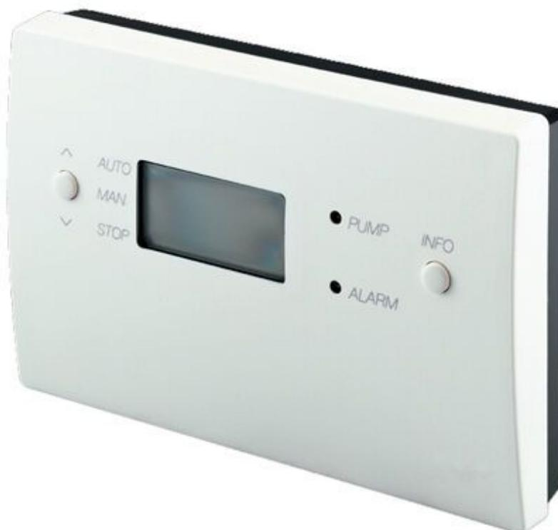
Danfoss Solarregler werden für die Warmwasser-Durchflussregelung und Pumpensteuerung eingesetzt. Die Umwälzpumpe des Solarheizkreislaufrs wird durch die Temperaturdifferenz zwischen dem Solarkollektor und dem Warmwasserspeicher geregelt.
