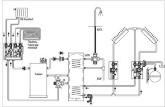
Beispiel: Integration einer Solaranlage in eine Heizungsanlage
