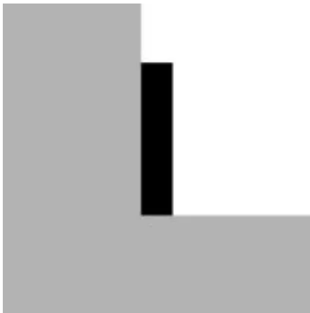
Sockelprofil aufgesetzt | Fußleisten aus Aluminium mit Clipsanker für die unsichtbare Befestigung auf die Wandfläche.
