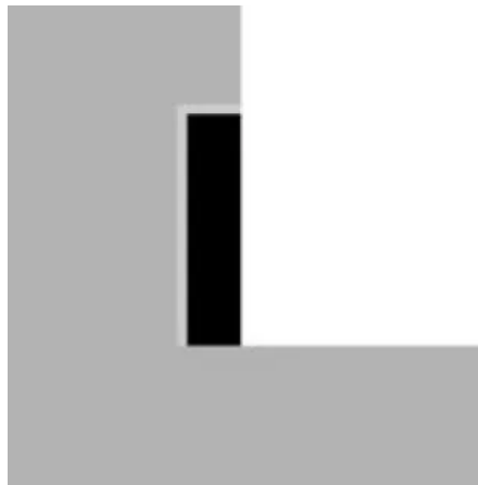
Sockelprofil wandbündig | Fußleisten mit Grundprofil und Deckprofil aus Aluminium, für die Kombination mit Bodenbelägen oder für die Auffütterung mit Holzleisten.
