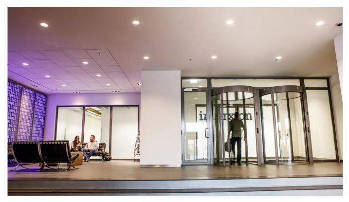
Für besonders sicherheitsrelevante Bereiche bieten Hochsicherheits-Karusselltüren und -Portale nachweislich Schutz gegen unbefugtes Eindringen. Diese Eingänge bieten Barrieren in voller Höhe, die ein Durchkriechen oder Übersteigen verhindern, sowie hochentwickelte Sensortechnologien, die Tailgating- und Piggybacking-Versuche unterbinden. Sie bieten Schutz für Mitarbeitereingänge, Geräteräume in Rechenzentren, Aufbewahrungsorte für vertrauliche Dokumente und die Vorstandsetage.
