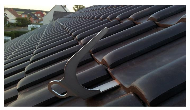
Sicherheitsdachhaken für geneigte Dächer zum Einhängen von Dachdeckerleitern sowie zur Befestigung der Persönlichen Schutzausrüstung gegen Absturz (PSAgA). Sicherheitsdachhaken LUX-top® SDH sind geeignet für geneigte Dächer und Steildächer mit Biberschwanz-, Schiefer-, Stehfalz- und Ziegeleindeckung.
