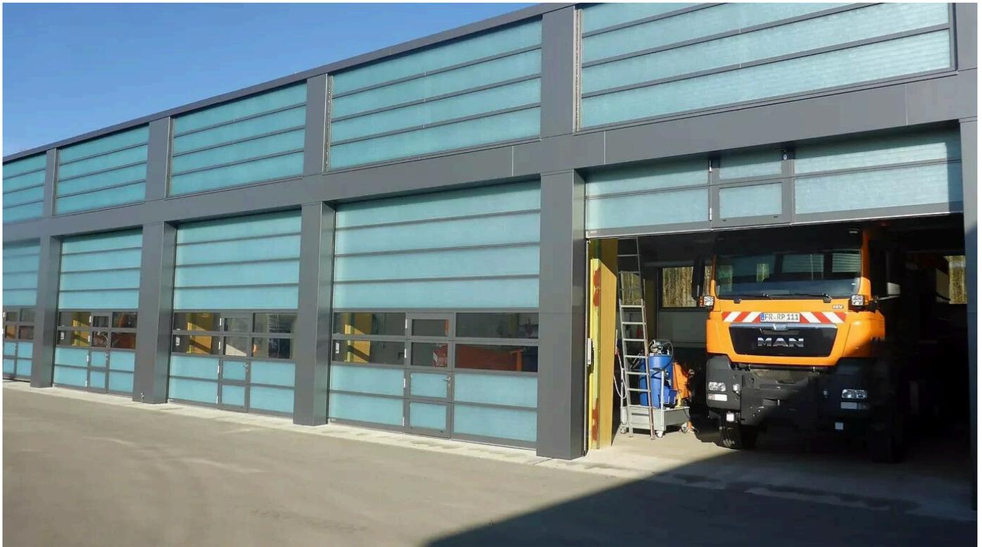
Sektionaltore SECTIOLITE verfügen über hohe Öffnungsgeschwindigkeiten und sind flexibel einsetzbar. Die Sektionaltore SECTIOLITE Security sind als Sicherheitstore RC3 zertifiziert. SECTIOLITE Sektionaltore sind auch für Bausituationen mit geringer Sturzhöhe bestens geeignet. Beim Öffnen schieben sich die einzelnen Torelemente der Sektionaltore aneinandergereiht platzsparend unter die Decke.
