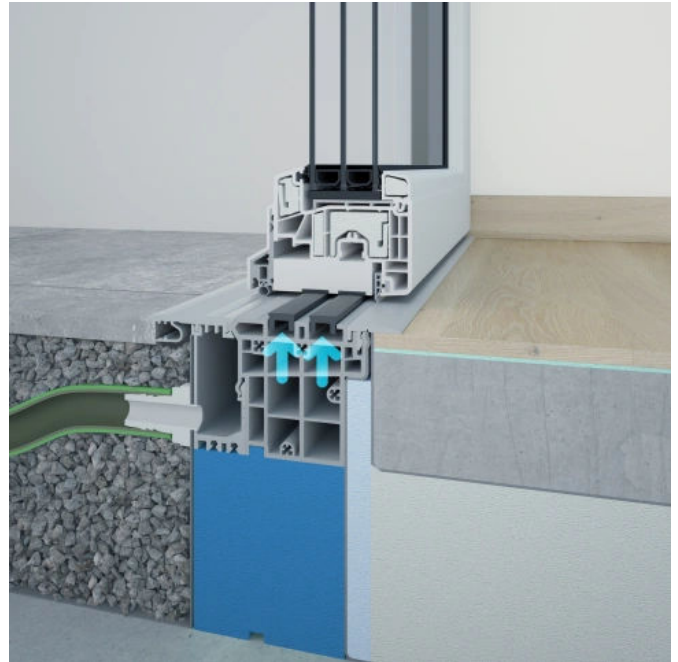
Tür geschlossen – Magnete oben (absolut dicht)
