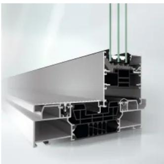
Das Schüco Schiebessystem ASE 80.HI TipTronic bietet zwölf unterschiedliche Öffnungsvarianten bei der Planung automatisch angetriebener Schiebessysteme an. Die Aluminium-Profile ermöglichen in Kombination mit der speziell entwickelten Antriebs- und Steuerungstechnologie großformatige Konstruktionen mit Flügelgewichten bis zu 600 kg und Flügelwegen bis zu 18 m. Dabei sorgen integrierte Sensoren einen sicheren Betrieb.
