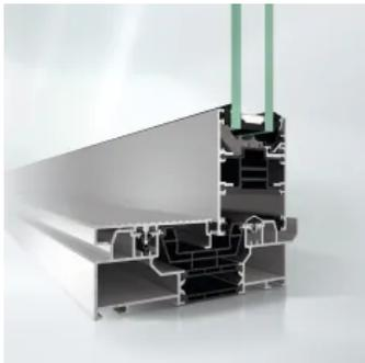
Das Schüco Schiebesystem ASE 60 TipTronic bietet zwölf unterschiedliche Öffnungsvarianten bei der Planung automatisch angetriebener Schiebesysteme an. Die Aluminium-Profile ermöglichen in Kombination mit der speziell entwickelten Antriebs- und Steuerungstechnologie großformatige Konstruktionen mit Flügelgewichten bis zu 600 kg und Flügelwegen bis zu 18 m. Dabei sorgen integrierte Sensoren für einen sicheren Betrieb.
