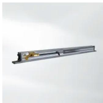
Per Dämpfermechanik wird mit Schüco SmartStop der Fahrflügel beim Schließen außerhalb der möglichen Klemmzone gestoppt – auch bei sehr schneller Beschleunigung. Anschließend kann der Flügel in den Blendrahmen geschoben und manuell verriegelt werden.
