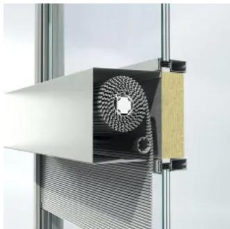
Dieses Schüco Sonnenschutzsystem CTB (Concealed Toughened Blind) ist in einem Kasten verbaut, der vor den Fassadensystemen Schüco FWS 50 und Schüco FWS 60 installiert werden kann – auch als Nachrüstung. Der aufrollbare Sonnenschutzbehang wird über seine gesamte Breite durch eine gummierte Welle geräuscharm umgelenkt und läuft so sicher in die Einlaufführungen und Führungsschienen ein.
