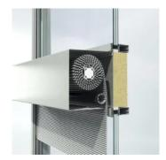
Dieses Schüco Sonnenschutzsystem CTB (Concealed Toughened Blind) ist in einem Kasten verbaut, der vor den Fassadensystemen Schüco FWS 50 und Schüco FWS 60 installiert werden kann – auch als Nachrüstung. Der aufrollbare Sonnenschutzbehang wird über seine gesamte Breite durch eine gummierte Welle geräuscharm umgelenkt und läuft so sicher in die Einlaufführungen und Führungsschienen ein.
