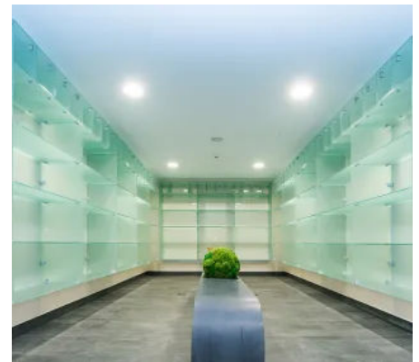
Glasregal Typ Vitrums III aus satiniertem Glas. Die Verbindung der Glasscheiben erfolgt mittels eloxierter Aluminiumbeschläge.
