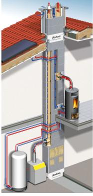
Der Energiesparschornstein für Feuerstätten aller Art mit raumluftabhängiger und raumluftunabhängiger Betriebsweise. Werkseitig gedämmte Compound-Mantelsteine und keramische Profilinnenrohre sowie der optimierte Thermo-Trennstein sichern hohe Energieeinsparung und reduzierten CO2 Ausstoß.
