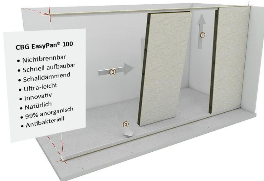
Das System besteht aus natürlichen, feuerfesten, schalldämmenden CBG EasyPan® 100 Composite-Sandwich-Paneele auf Basalt-Keramikbasis. Die Paneele sind nichtbrennbar (A2) gemäß DIN-4102 und EN-13501 und zeichnen sich durch ihre Leichtigkeit und einen extrem geringen Montagezeitaufwand, sowie durch eine solide Schall- und sehr gute Wärmedämmung aus. Bei dem Produkt ist der Brand- und Schallschutz bereits als Standard enthalten.
