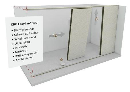
Das System besteht aus natürlichen, feuerfesten, schalldämmenden CBG EasyPan® 100 Composite-Sandwich-Paneelen auf Basalt-Keramikbasis. Die Paneele sind nichtbrennbar (A2) gemäß DIN-4102 und EN-13501 und zeichnen sich durch ihre Leichtigkeit und einen extrem geringen Montagezeitaufwand, sowie durch eine solide Schall- und sehr gute Wärmedämmung aus. Bei dem Produkt ist der Brand- und Schallschutz bereits als Standard enthalten.
