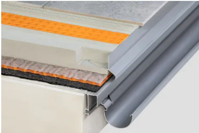
Abschlussprofil BARA-RK mit Abdichtungs- und Entkopplungsmatte DITRA auf Drainagematte TROBA-PLUS
