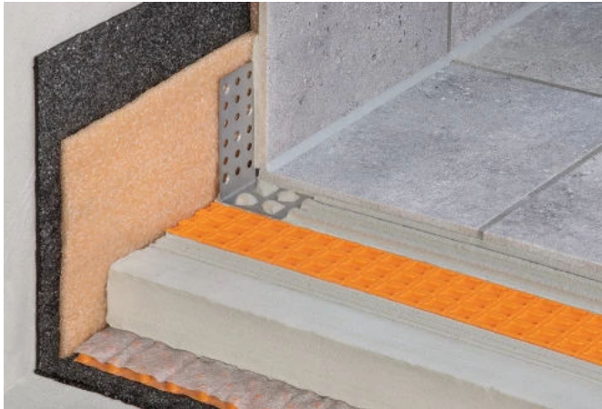
Trägerprofil BARA-ESOT mit Abdichtungs- und Entkopplungsmatte DITRA
