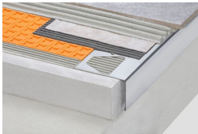
Abschlussprofil aus Edelstahl BARA-RW mit KERDI-KEBA und Abdichtungs- und Entkopplungsmatte DITRA
