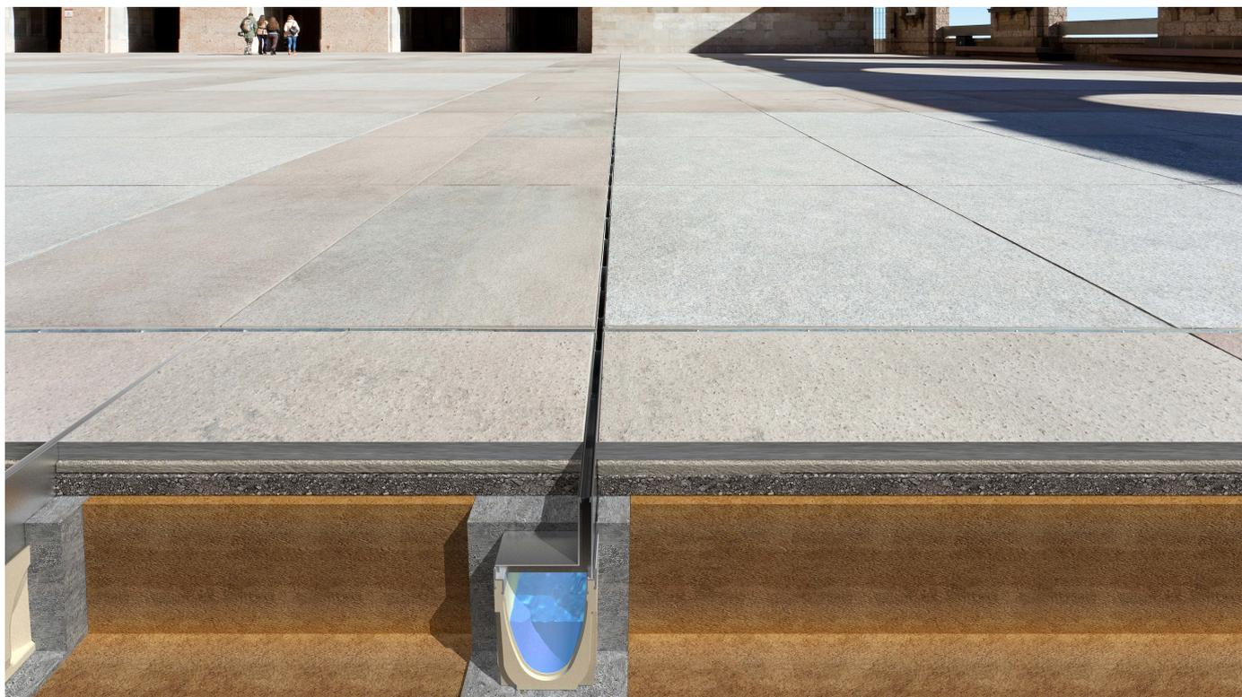
Schlitzrinnen für die ästhetische und leistungsstarke Entwässerung mit vollständiger Integration in Belägen aus Betonplatten, Pflastersteinen oder Fliesen. ULMA Schlitzrinnen bilden ein Komplettsystem aus Polymerbeton-Rinne, Revisionsöffnung und Schlitzaufsatz. ULMA Schlitzaufsätze sind mit Einzel- oder Doppelschlitz aus Stahl oder Edelstahl für verschiedene Rinnensysteme bis Belastungsklasse D400 erhältlich.
