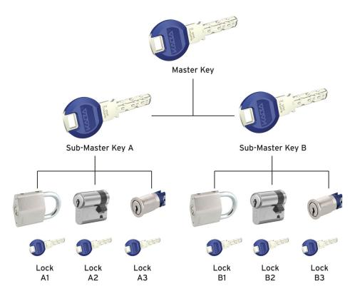
Schließanlagen haben einen Schließplan, nach dem ausgewählte Schlüssel eine Reihe bestimmter Türen öffnen können. Dieser hilft, die Kontrolle zu behalten, spart Kosten für Ersatzschlüssel und ist praktisch, da weniger Schlüssel im Umlauf sind. Sie bietet auch schnellen Zutritt zu allen Räumen, z.B. für Sicherheits- und Managementpersonal.
