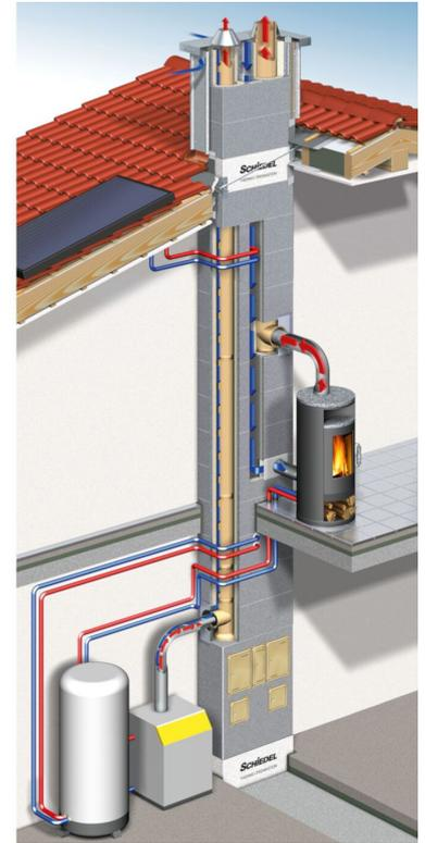
Der Energiesparschornstein für Feuerstätten aller Art mit raumluftabhängiger und raumluftunabhängiger Betriebsweise. Werkseitig gedämmte Compound-Mantelsteine und keramische Profilinnenrohre sowie der optimierte Thermo-Trennstein sichern hohe Energieeinsparung und reduzierten CO<sub>2</sub> Ausstoß.
