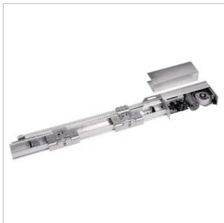
Schiebetürantrieb für den Krankenhaus / Klinikbereich (z.B. OP-Türen) oder bei Inwand-Montage. Die geringe Bautiefe des Antriebs ermöglicht die vollständige Integration in die Türzarge. Die besonderen Nutzungsanforderungen wie die Push & Go Funktion oder die Betten- oder Teilöffnung sind in die Grundsteuerung bereits integriert.
