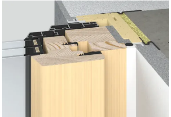
Premium-Montagesystem: Innen mit Verfugung
