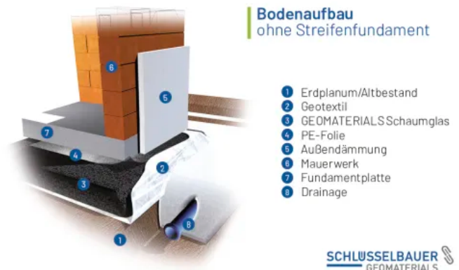
Systemskizze Bodenaufbau ohne Streifenfundament
