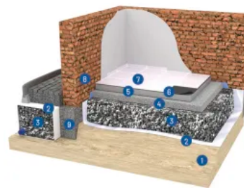
Systemskizze Sanierung Vertikale Mauer- und Drainageschüttung
