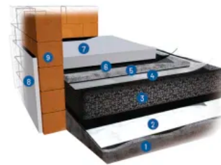
Systemskizze Aufbau ohne Bodenplatte mit Estrich
