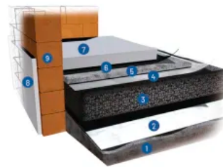
Systemskizze Aufbau ohne Bodenplatte mit Estrich
