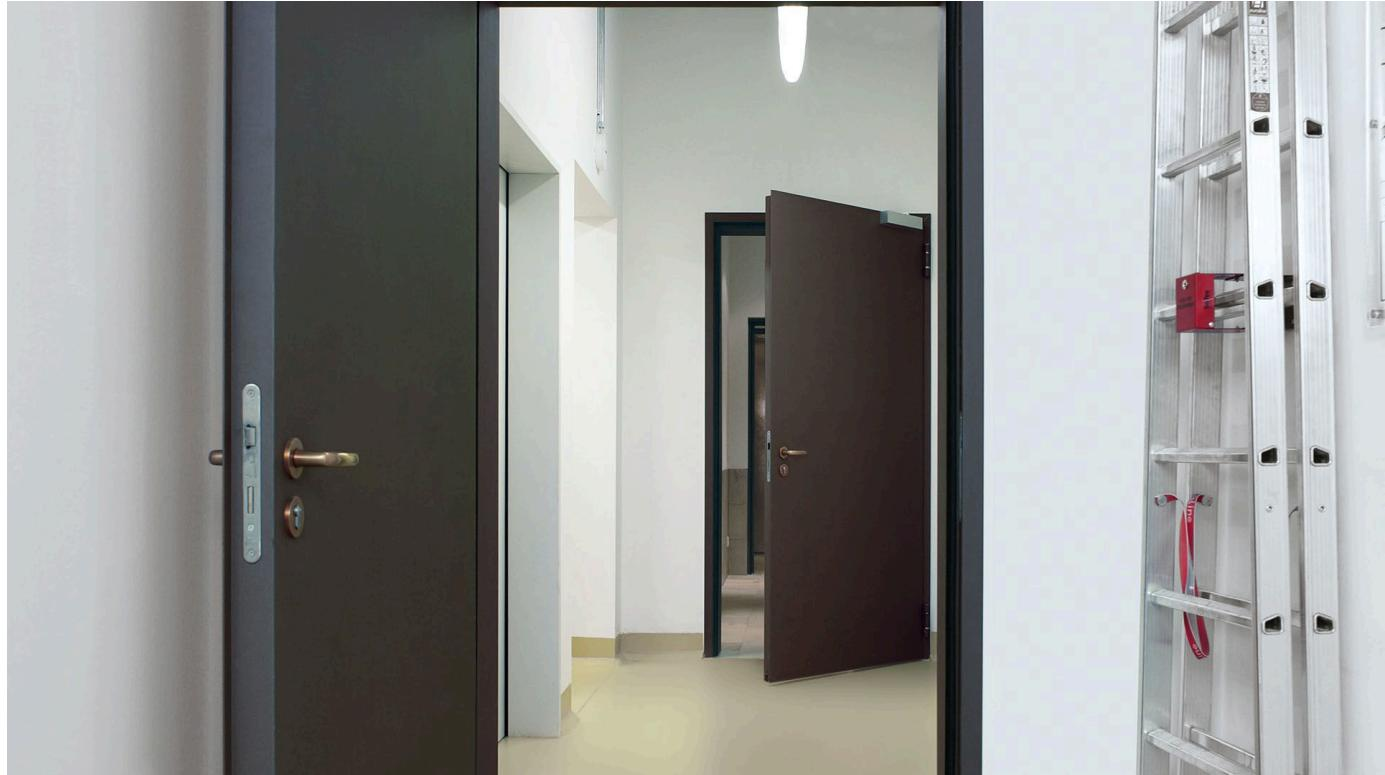
Schallschutztüren von Teckentrup Door Solution sorgen im gewerblichen Bereich bei Räumen mit hohem Lärmaufkommen dafür, dass die Geräusche nicht nach außen dringen. Bei Wohn- oder Bürogebäuden werden die innenliegenden Bereiche gegen Geräusche von außen abgeschirmt.
