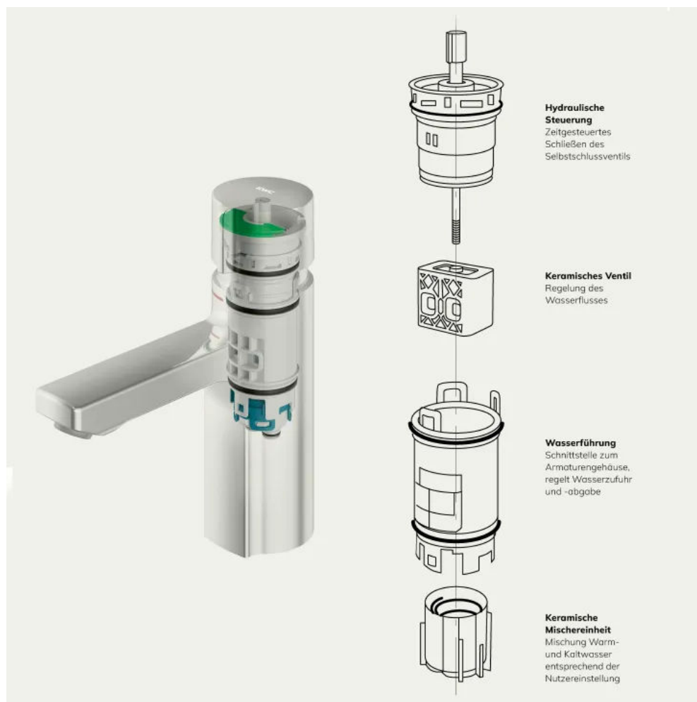
FRAMIC – Selbstschluss-Mischkartusche
