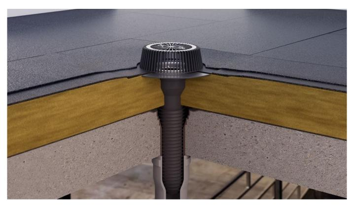
Dallmer Sanierungsabläufe ermöglichen eine kostengünstige und schnelle Sanierung von Ablaufstellen auf dem Dach. Der alte Ablauf kann im Dachaufbau verbleiben, der Sanierungsablauf wird bis in den Stutzen des Altablaufs "durchgesteckt".
