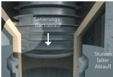
Der Sanierungs-Dachablauf 63 T passt in alle normgerechten Stutzen. Er kann eingesetzt werden, wenn eine Wärmedämmung mit Dachbahn oder nur die neue Dachbahn zur Sanierung verlegt wird.
