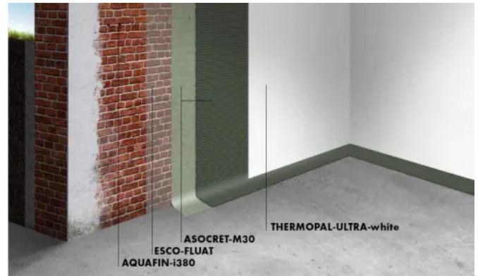
THERMOPAL-Sanierputz-System 1: Das Tagessystem ermöglicht die Flächen-Egalisierung und -Abdichtung und einen oberflächenfertigen, weißen Sanierputz in je einem Arbeitsgang.
