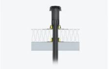
F. Für Be- und Entlüftung bei komplettem Neuaufbau des Daches:. SitaVent Systemlüfter
