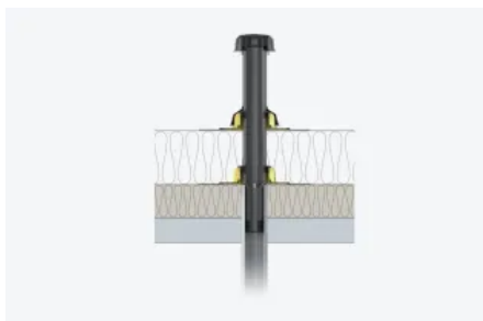
E. Für Be- und Entlüftung in das bestehende Rohr: SitaVent Sanierungslüfter
