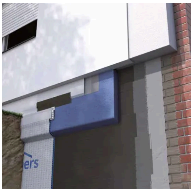
Systemlösungen für hinterlaufsichere Abdichtungen (© Remmers)
