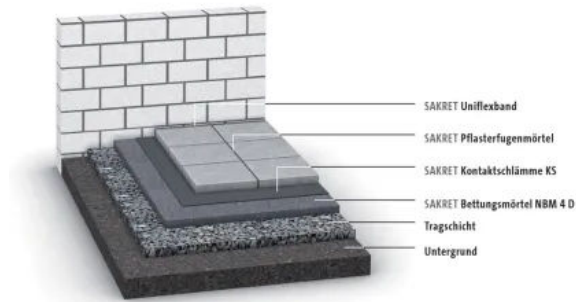
SAKRET Systemaufbau für den wasserdurchlässiger Plattenbelag
