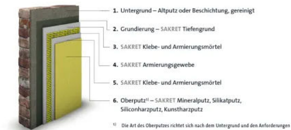
SAKRET Systemaufbau für die Putzsanie rung
