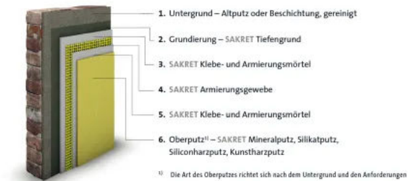
SAKRET Systemaufbau für die Putzsaniierung
