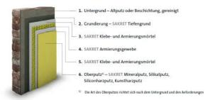
SAKTRET Systemaufbau für die Putzsanierung
