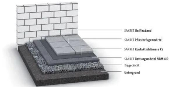
SAKRET Systemaufbau für den wasserdurchlässiger Plattenbelag
