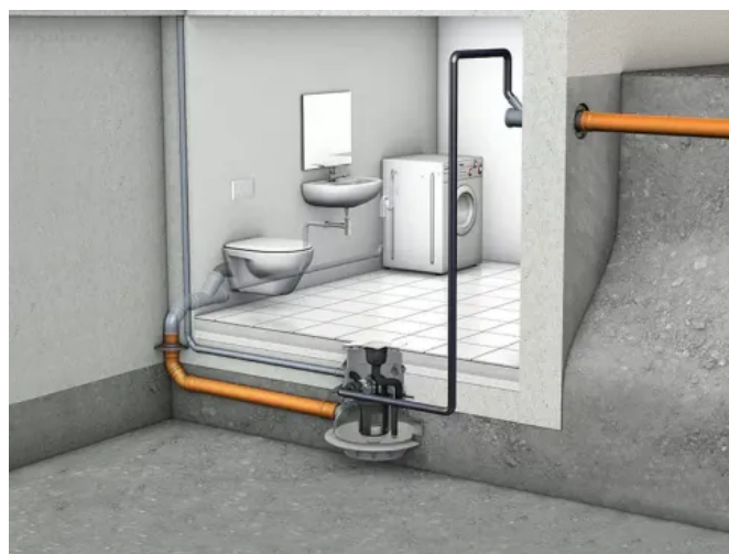
Hebeanlagen für fäkalienhaltiges Abwasser / Schwarzwasser
