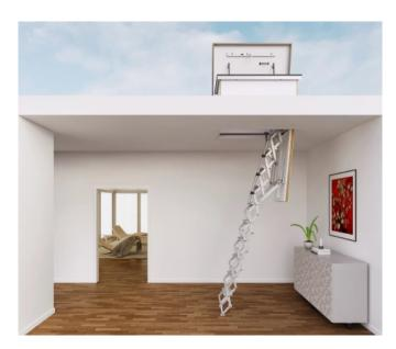
Der Flachdachausstieg Exklusiv hat einen, wetterfesten Lukenkasten aus verleimter Filmschichtplatte (21 mm) mit zwei umlaufenden Dichtungen. Das komplette Element ist wasserabweisend und fungizid behandelt.
