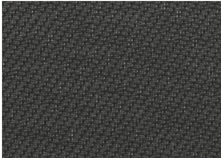
Glasfasergewebe | Gewebe aus PVC-ummantelten Glasfasergarnen, Webart Sergé (© Deluxe-Images)
